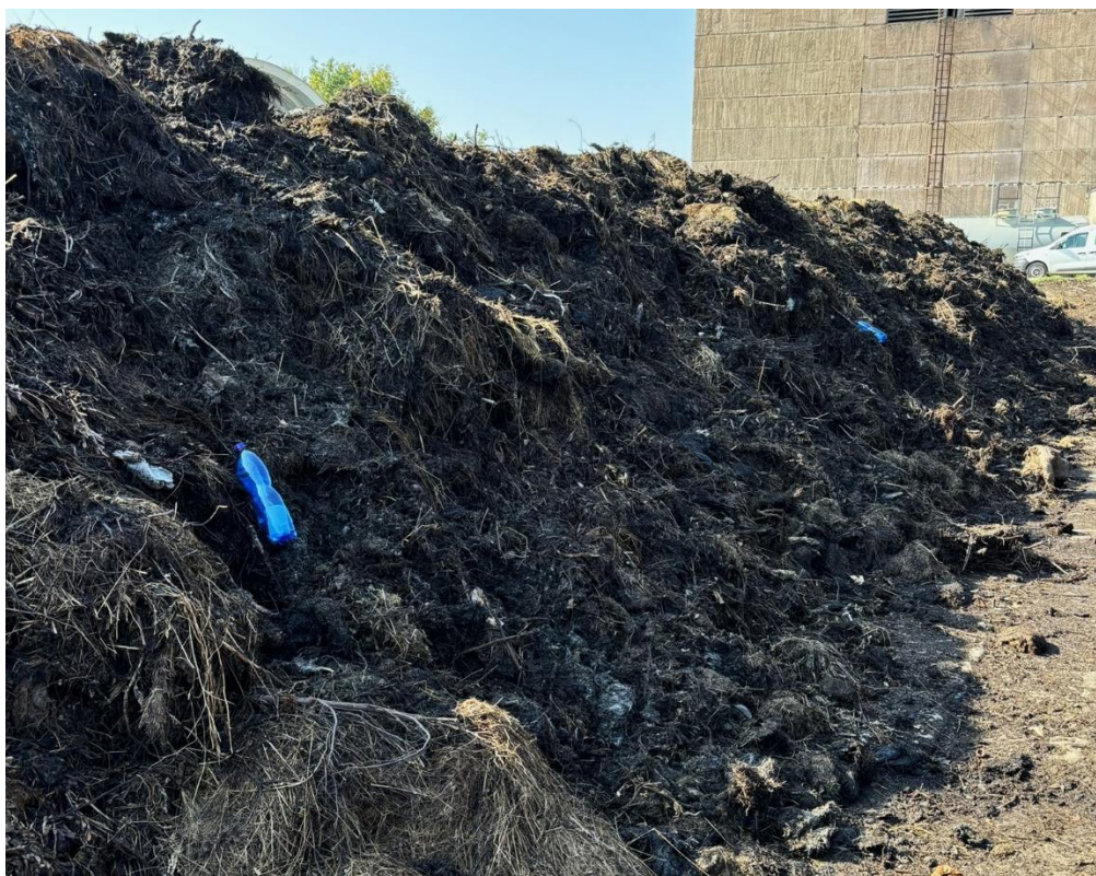
Obrázek 3. Umístěné testovací systémy s vnesenými indikátorovými mikroorganismy na začátku ověření, Kompostárna Hořátev, 20. 8. 2024.
