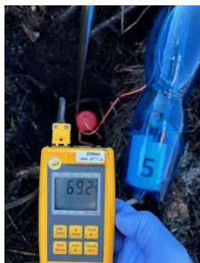
Obrázek 2. Detail vneseného testovacího systému před zakopáním.
